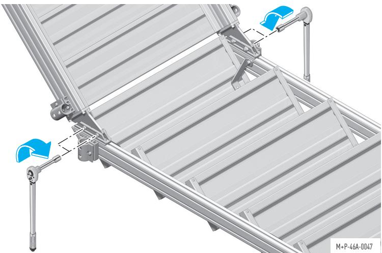
Handlauf/Geländer montieren / Installing handrail / platform / Montage de la rambarde/du garde-corps / Handloop/leuning monteren
