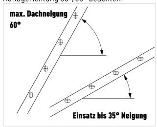
• Maximale Belastung der Dachleiter 150 kg
